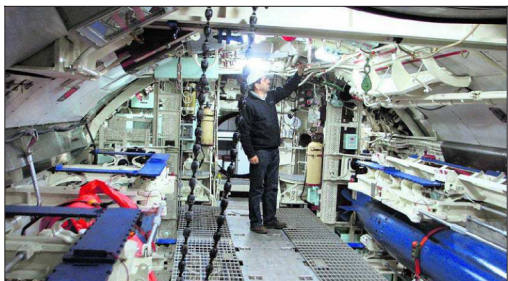
El interior de la nave se repintó con sus colores originales, al igual que sectores que presentaban niveles de corrosión. En la fotografía, la sala de torpedos.
